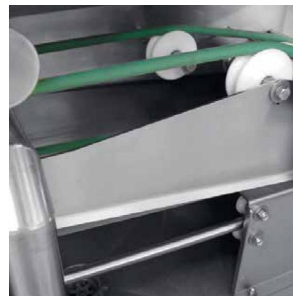
Lame d'aria di serie, alimentate dalle turbo soffianti, posizionate sia sopra che sotto il nastro permettono di togliere ogni velo d'acqua e lasciare il vassoio perfettamente asciutto, pronto per essere impilato e/o riutilizzato all'istante senza alcuna asciugatura manuale.
